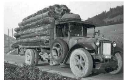
Der erste Lastwagen der OLWO, die «Marie», um 1935, mit Holzvergaser. Bild: zvg
