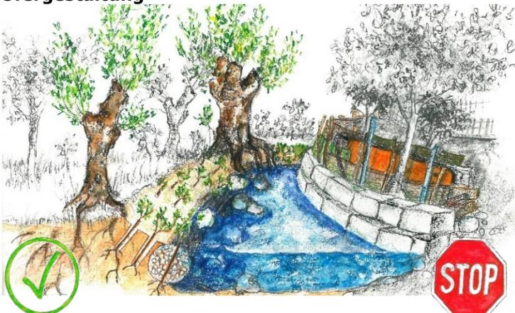
Improvisierte Ufersicherungen bieten keinen Schutz vor Hochwasser. Sie engen die Abflusskapazität ein und können durch Schwemmholz zum Verschluss von Engstellen führen. Hochwasserschutzmassnahmen, Ufersicherungen oder die Wiederherstellung von natürlichen Ufern müssen mit Vertretern des Kantons abgesprochen werden und eine Bewilligung ist erforderlich.
