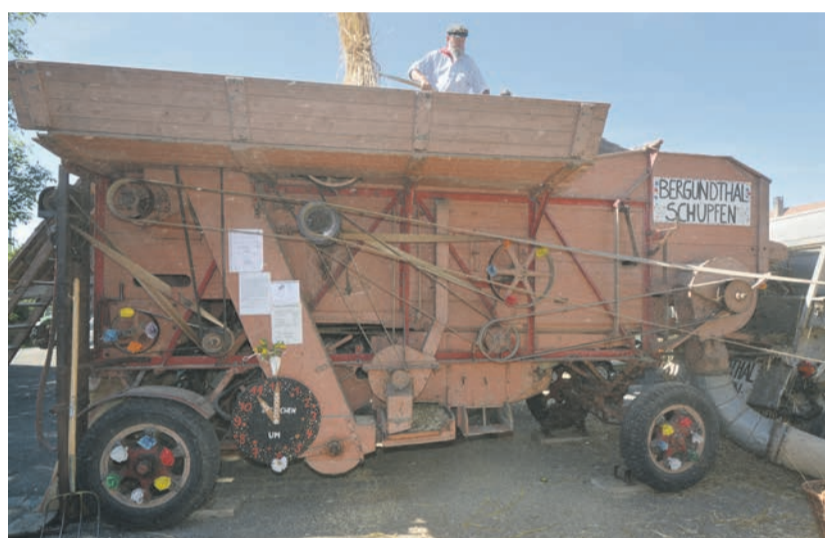
Mehranbau der Bergundthal drescht 20 Bundessäcke à 100 Kilo pro Stunde. Pro Sack gab es seinerzeit gut 100 Franken, heute erzielt man dafür etwas die Hälfte.
