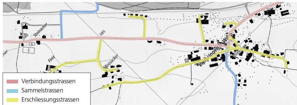
Abbildung 2: Hierarchie des Strassennetzes
