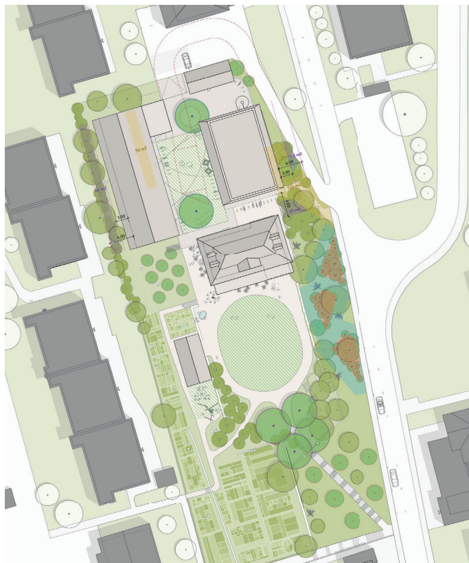
Abb. 11 Situationsplan Dachaufsicht mit Umgebungsgestaltung, Stand Februar 2023 (Quelle: ARGE akkurat futurafrosch meta)
