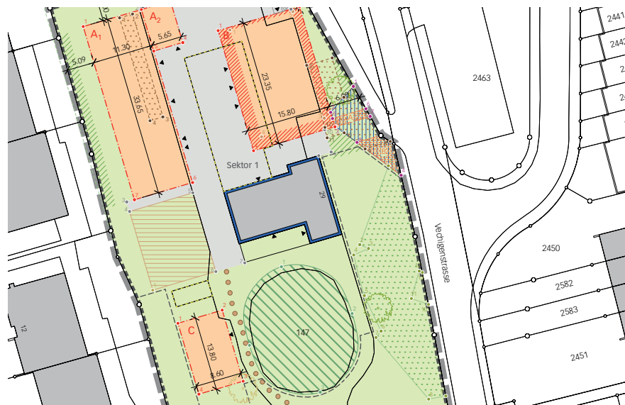
Abb. 28 Ausschnitt Überbauungsplan: Die zu entfernenden Hecken-/Feldgehölzflächen sind mit einer braunen Schraffur dargestellt. Die bestehenden bestockten Flächen, zu denen Bauabstände unterschritten werden, sind mit einer grünen Schraffur dargestellt und die massgebenden Bauabstände hinweisend ergänzt. Im Bereich der grün punktierten Fläche sollen entsprechende Ersatzmassnahmen realisiert werden.
